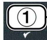
11. Die Taste **✓ (1 JA)** drücken, wenn das Becken gefüllt ist. Die Taste **x (2 NEIN)** drücken, um die Pumpe erneut einzuschalten\*. Wenn das Becken nicht komplett mit Fett gefüllt wird, die Filterwanne prüfen, um zu
