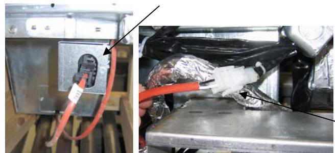
**Abbildung 3:** Befestigen Sie die zwei-poligen weißen Stecker und stecken Sie den schwarzen Stecker in den Utility-Box wie gezeigt.
